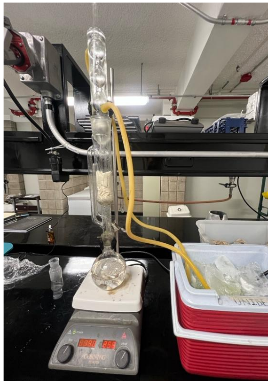
Figura 4. Preparación del extractor Soxhlet
